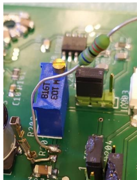
Rys.2. W miejsce rezystora smd wlutowany rezystor tht. Na drugim padzie złącze pozwalające wrócić do połączenia pierwotnego poprzez wetknięcie wolnej końcówki rezystora.
