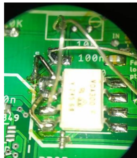
Rys. 3. Najbardziej dorodny okaz z mojej kolekcji, powstały w ramach prototypowania kolejnej wersji układu na istniejącej płytce. Znajdziecie tu: rezystor smd postawiony na sztorc i połączony sztywnym drucikiem do testpointa opisanego „feed loop pt.2”; połączenie potrójne z jednego drucika między padem układu scalonego, otworem po usunięciu w ramach modyfikacji potencjometrze i testpointem na przeciętej ścieżce; połączenia z użyciem drucików z goldpinów; zwarte sąsiadujące pady; uniesioną nóżkę (1) układu scalonego; ścieżkę przeciętą i zwartą do przelotek które miały na celu jej ominięcie.
