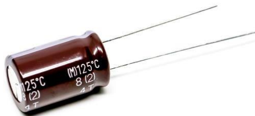
Widok zasilacza: radiatory tranzystorów kluczujących z radiatorami i kondensatory filtrujące; płyta główna komputera – gniazdo procesora i kondensatory filtrujące; kondensator elektrolityczny z naniesioną informacją o temperaturze pracy.
