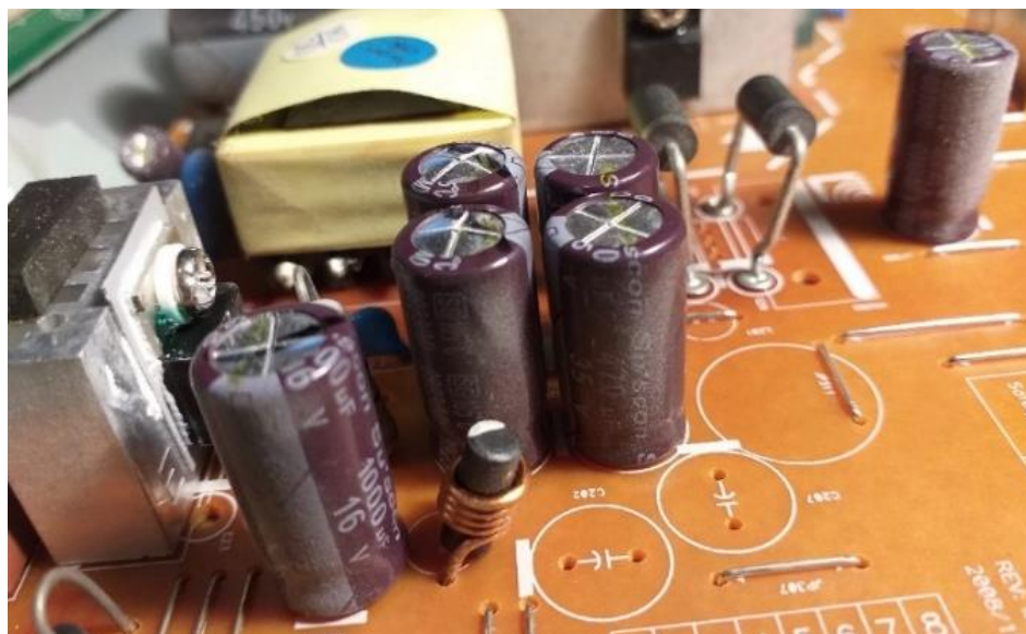
Widok zasilacza - radiatory tranzystorów kluczujących z radiatorami i kondensatory filtrujące.
